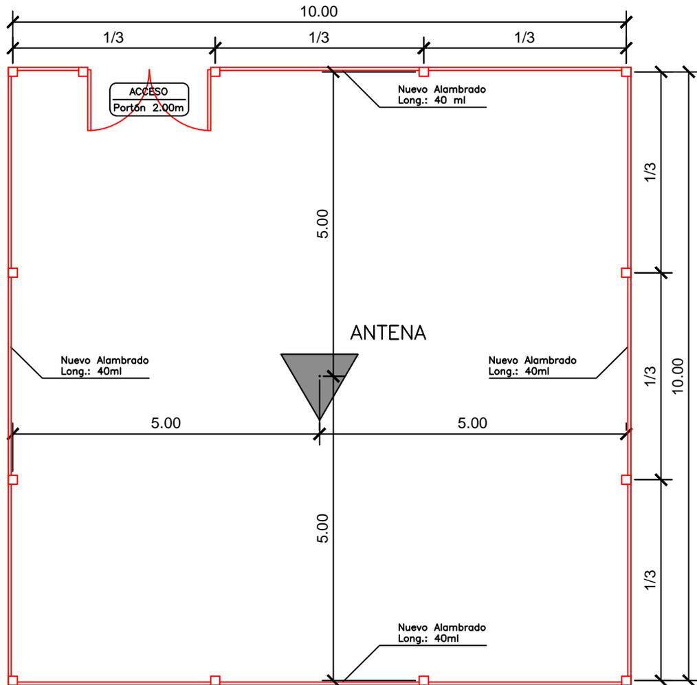
Nuevo alambrado olímpico, perimetral a la antena (h:2.40m) ubicado dentro del predio de la planta transmisora de LRA 23 San Juan según especificaciones del pliego
