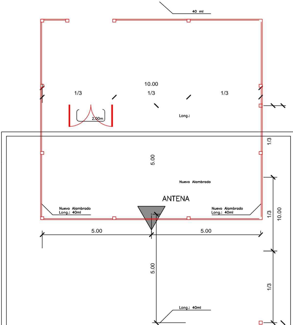
Nuevo alabrado perimetral a la antena ubicada del predio de la planta transmisora de LT 12 los libres según detalles del pliego
