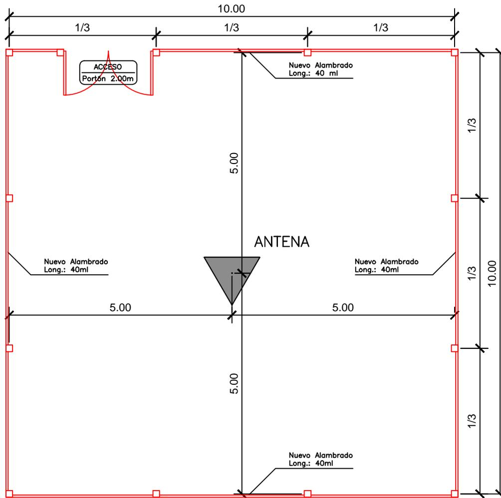
Nuevo alambrado perimetral a la antena ubicada dentro del predio de la planta transmisora de LRA5 Rosario según detalles del pliego
