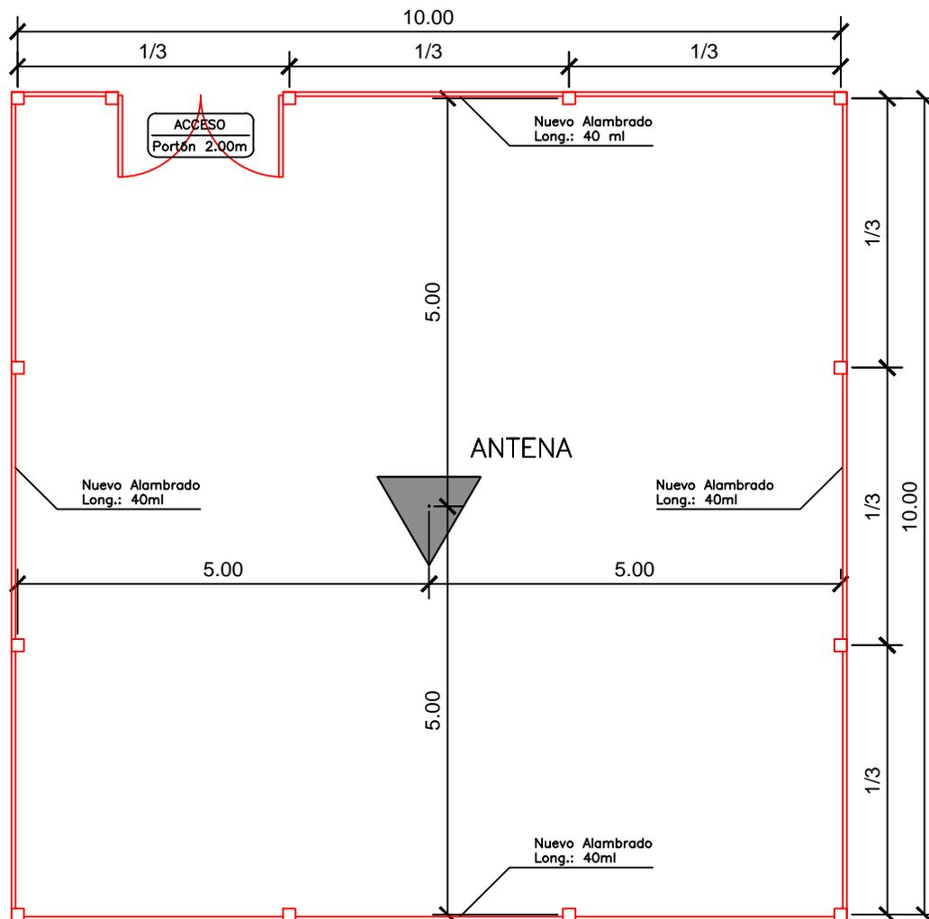
Nuevo alabrado perimetral a la antena ubicada dentro del predio de la planta transmisora de LU 23 Calafate según detalles del pliego
