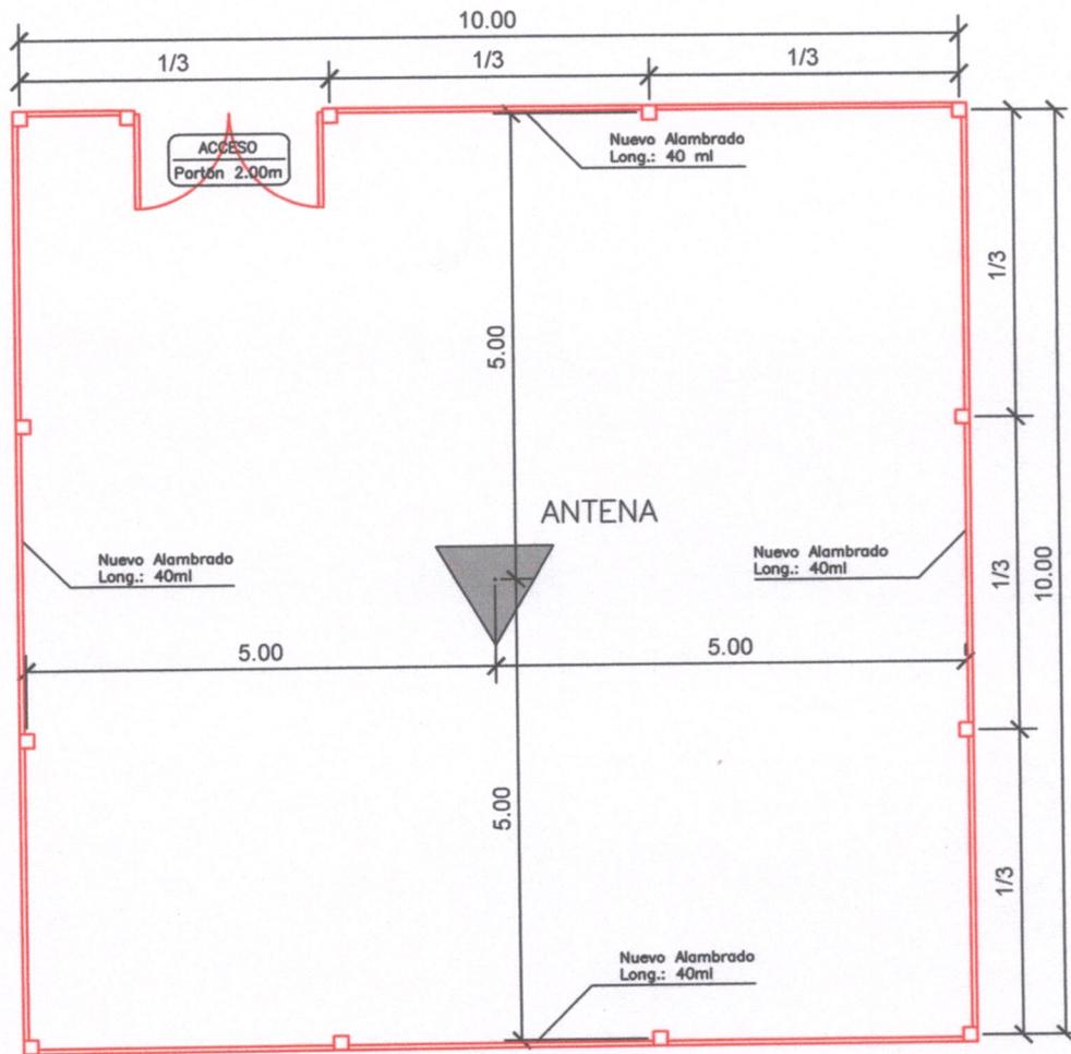
Nuevo alambrado perimetral a la antena ubicada dentro del predio de la planta transmisora de LRA 53 San Martín de los Andes según detalles del pliego
