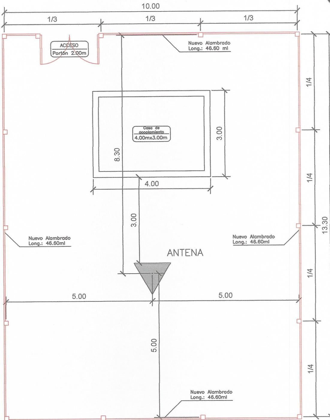
Nuevo alambrado perimetral a la antena ubicada dentro del predio de la planta transmisora de LRA 19 Puerto Iguazú según detalles del pliego
