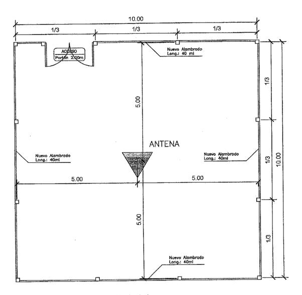
Nuevo alambrado perímetral a la antena ubicada dentro del predio de la planta transmisora de LRA 18 Río Turbio según detalles del pliego
